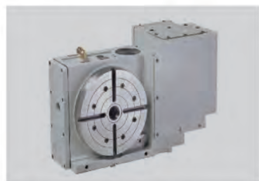
四轴CNC电脑数控分度盘：在操作的时候拥有精准的传动能力，而且背隙可轻松自如的调整，较长时间使用后，其精度仍然能够很好的维持。
