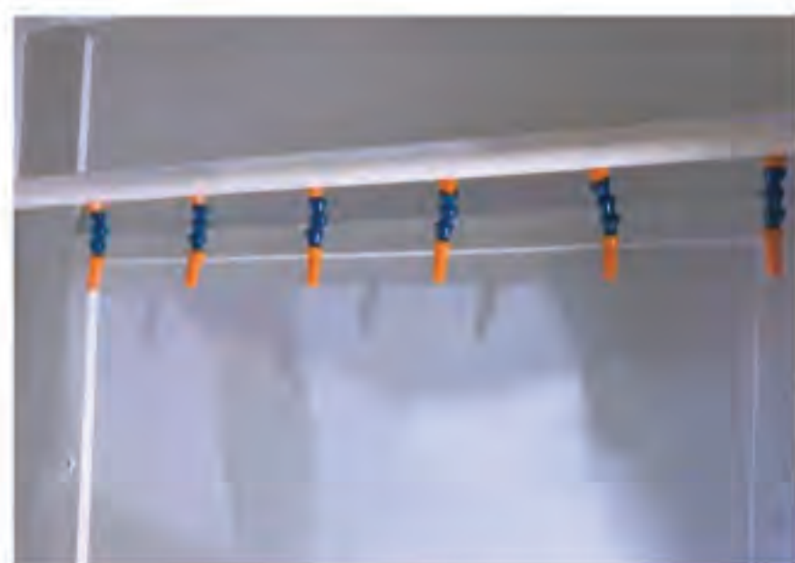
侧冲洗：侧冲洗安装在机内上部，有更好的清洗切屑的效果，使得在飞溅钣金侧面和切屑容易堆积的对方很容易去除。
