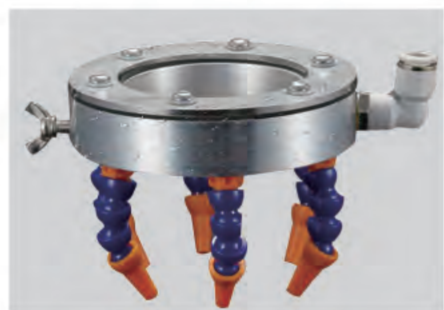
主轴头切削液喷嘴：喷嘴与刀具位置恒定，因此加工部位可得到充分的冷却。不可和刀具清洗选配项同时选择。
