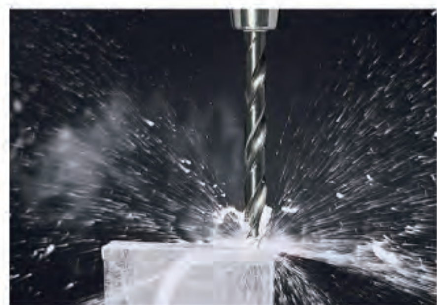
主轴中心出水：在BT主轴中可选中心出水装置（1.5MPa）。
